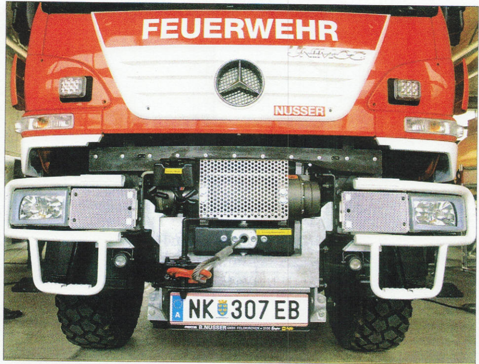
Robustes Fahrgestell und stabiler Aufbau für schwierige Geländeeinsätze. Eine 5,4 Tonnen Seilwinde ist ebenfalls mit an Bord.
