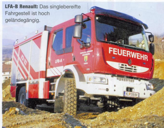
**LFA-B Renault:** Das singlebereifte Fahrgestell ist hoch geländegängig.
