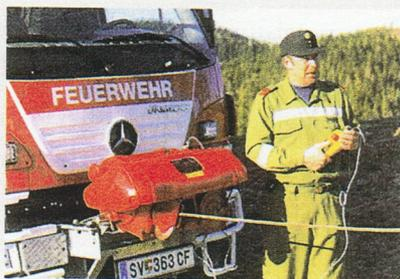
Wie sein Vorgänger verfügt das LF-A über eine Frontseilwinde. Bedient wird sie mit einer Kabelfernsteuerung, die direkt am Gerät angeschlossen werden kann.
