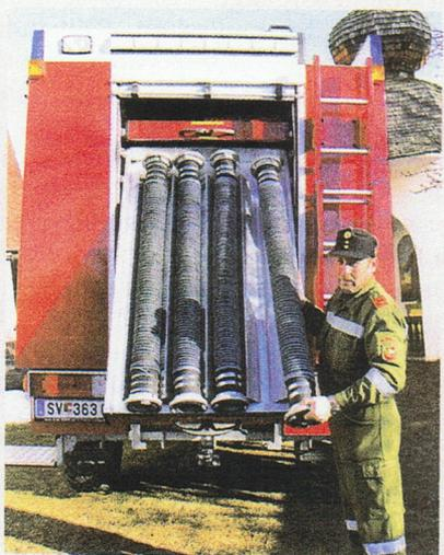
Vier A-Saugschläuche sind in dem Auszug am Heck untergebracht. Darüber lagert in einem weiteren Auszug Schanzwerkzeug, wie Schaufeln und Besen.
