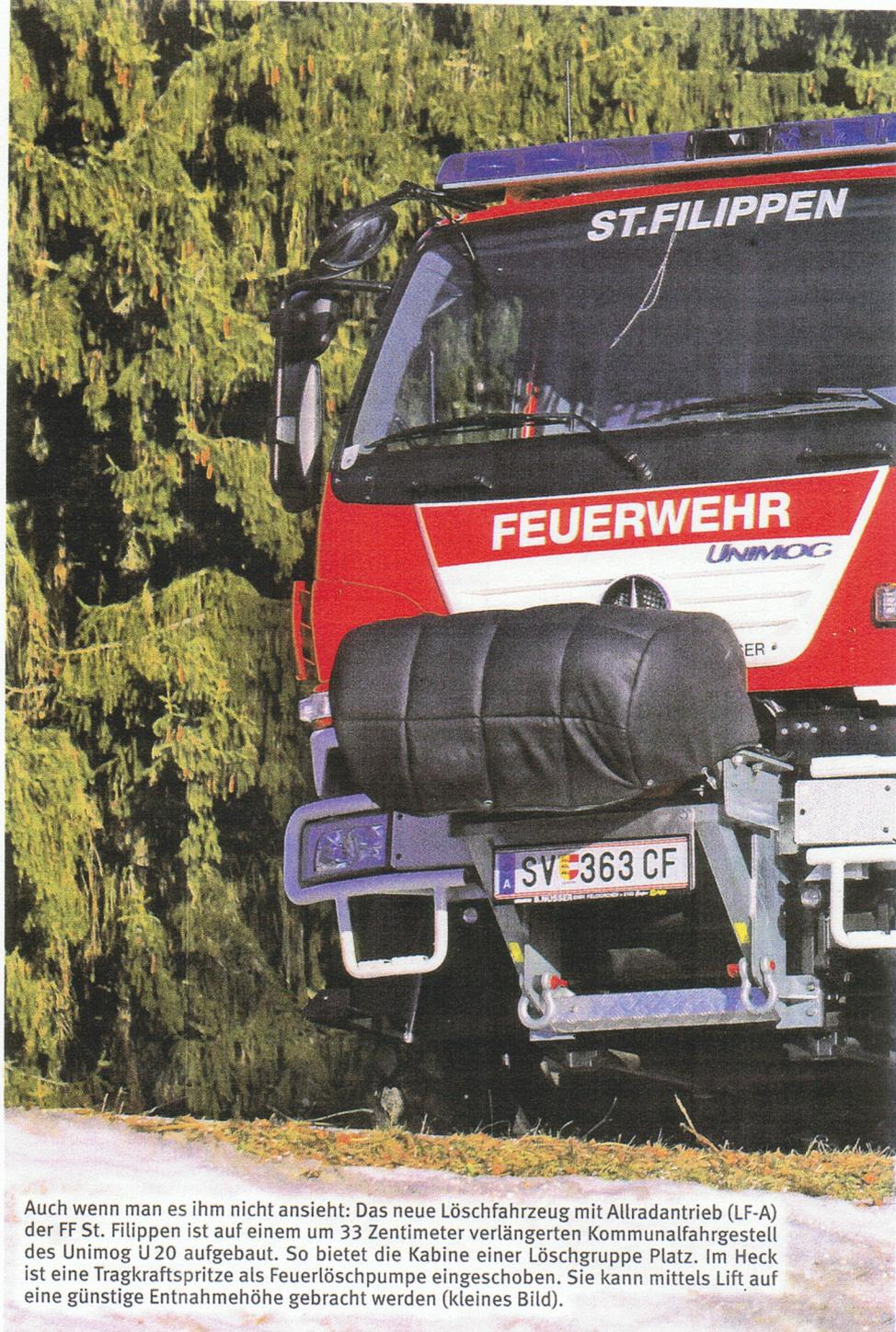
Auch wenn man es ihm nicht ansieht: Das neue Löschfahrzeug mit Allradantrieb (LF-A) der FF St. Filippen ist auf einem um 33 Zentimeter verlängerten Kommunalfahrzeuggestell des Unimog U 20 aufgebaut. So bietet die Kabine einer Löschgruppe Platz. Im Heck ist eine Tragkraftspritze als Feuerlöschpumpe eingeschoben. Sie kann mittels Lift auf eine günstige Entnahmehöhe gebracht werden (kleines Bild).
