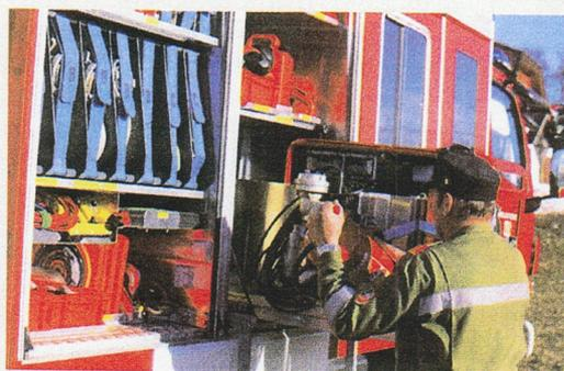
Stromerzeuger, Feuerlöscher und Motor-kettensäge nebst Zubehör sind auf der Beifahrerseite verstaut. Im G4 lagern Schläuche sowie die Hebekissen.
