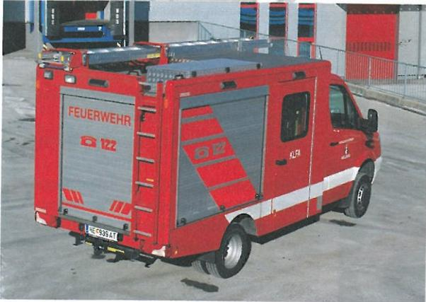
**Der Aufbau** vereint alle wesentlichen Komponenten eines Feuerwehrfahrzeuges, die Leiter ist von hinten entnehmbar.
