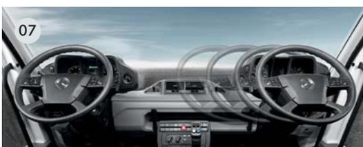
Mit der Wechsellenkung VarioPilot® wird das Lenkrad samt Pedalanlage in nur einem Bewegungsablauf von der linken auf die rechte Seite geschoben und arretiert. Je nach Arbeitssituation kann der Fahrer so entscheiden, ob er das Gerät wie gewohnt links oder rechts sitzend bedient.
