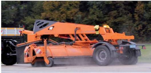
Das SPS-Kehrgerät reinigt die Landebahn vom restlichen Schnee.
