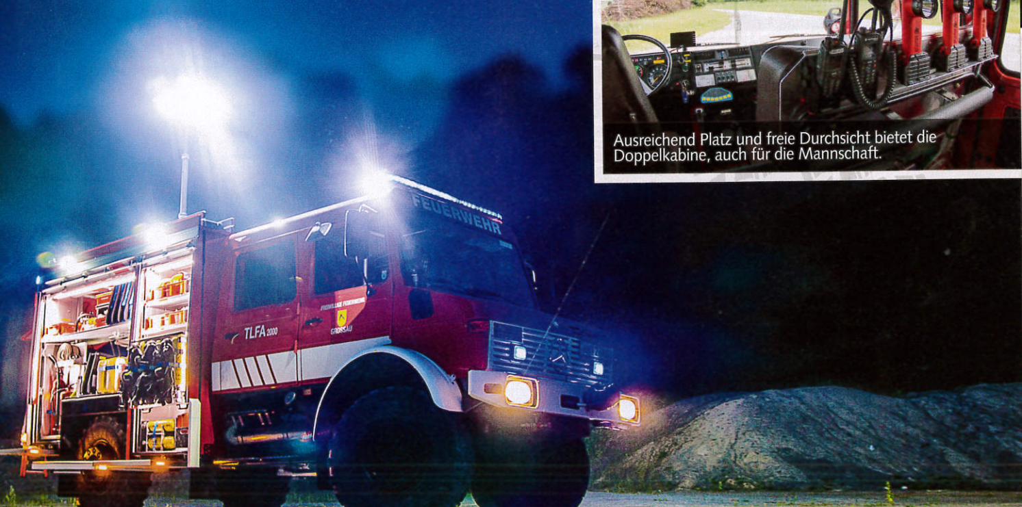
Im Zuge des Refurbishing des „alten“ Fahrzeuges wurde auch die Umfeldbeleuchtung sowie der Flutlichtmast auf LED-Leuchtmittel umgestellt.
